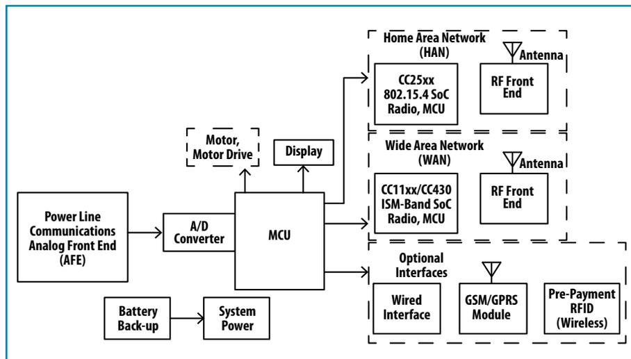
Figure 1. Smart Meter Block Diagram
